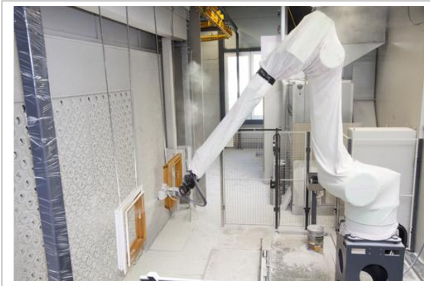
Die Holzfenster werden per Spritzrobotertechnologie mit Sikkens Wood Coatings Holzoberflächenbeschichtungen lackiert oder auch lasiert. Fotos: Akzo Nobel Wood Coatings GmbH – Sikkens Wood Coatings
