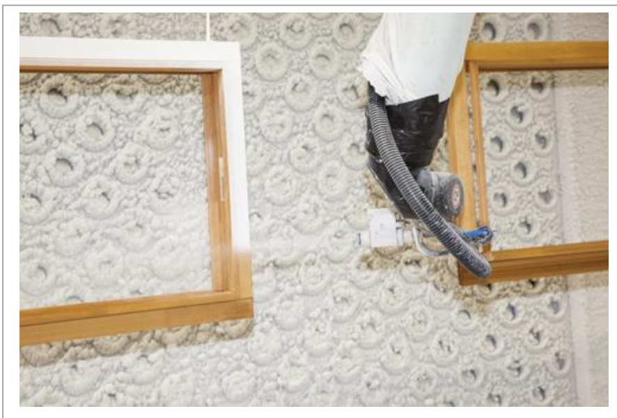
Die Spritzrobotertechnologie sorgt für eine absolut gleichmäßige Applikation der Sikkens Wood Coatings Holzoberflächenbeschichtungen. Fotos: Akzo Nobel Wood Coatings GmbH – Sikkens Wood Coatings
