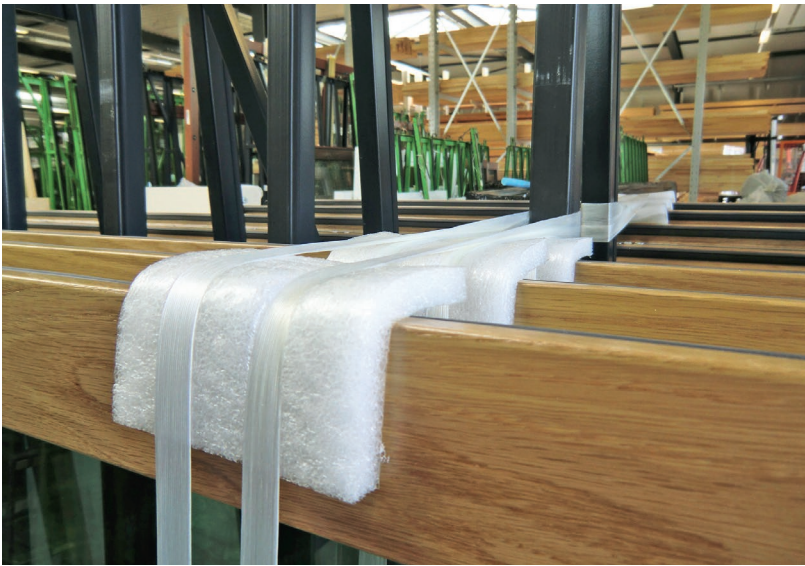
Beim Verpacken der Holz- und Holz/Alu-Fenster könnte nach Vanessa Laubers Untersuchungen eine Bandverpackungshilfe dazu beitragen, Material und Zeit einzusparen.
