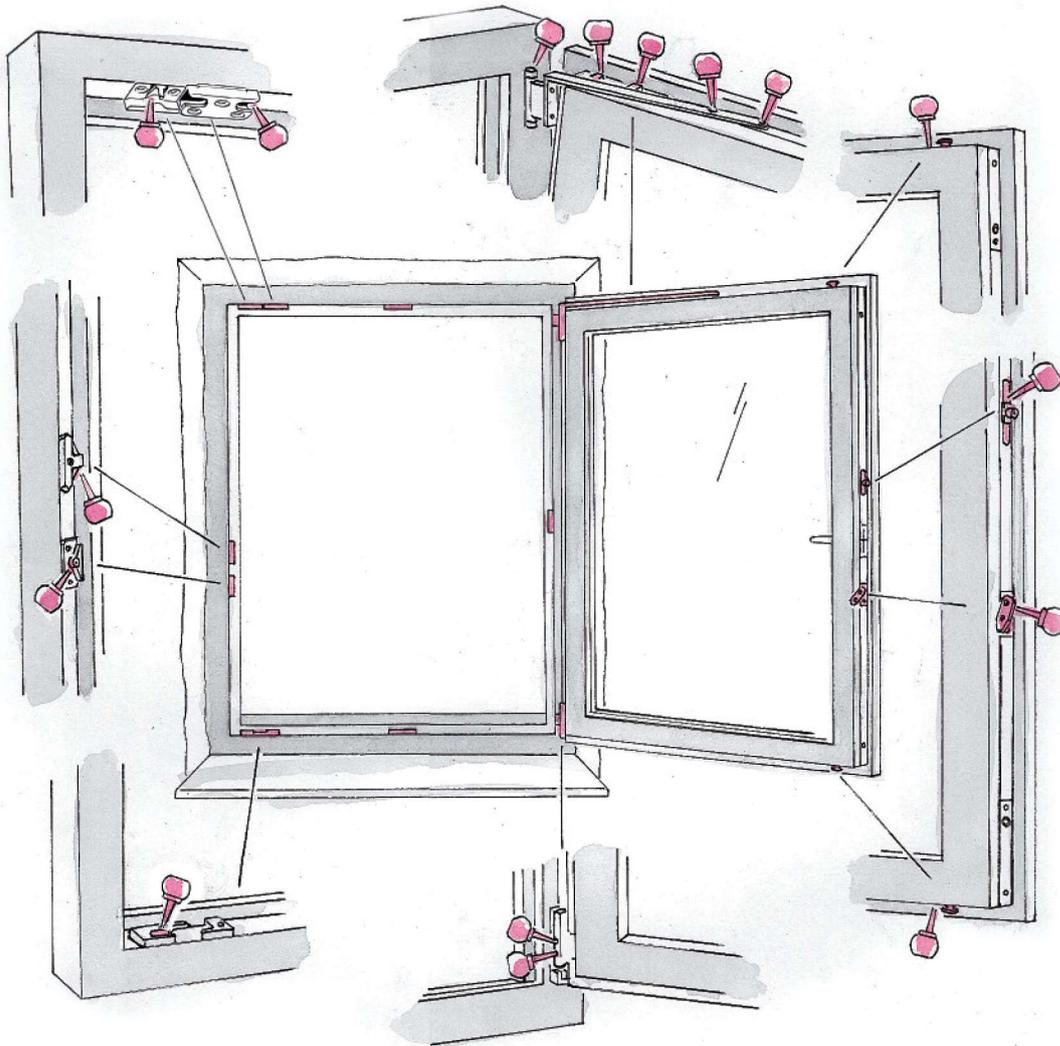
Durch regelmäßiges **Fetten und Ölen\*** (mind. 1x jährlich) aller funktionsrelevanten Bauteile in Flügel und Rahmen erhalten Sie sich die Leichtgängigkeit Ihrer Roto-Beschläge und schützen sie vor vorzeitigem Verschleiß. Sicherheitsschließstücke aus Stahl erfordern ständiges Einfetten, um unnötigen Abrieb zu vermeiden. Darüber hinaus ist der Sitz der Schrauben zu über-
