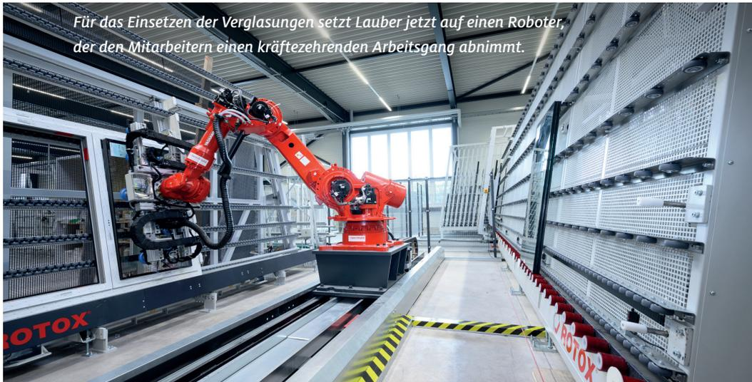
Für das Einsetzen der Verglasungen setzt Lauber jetzt auf einen Roboter, der den Mitarbeitern einen kräftezehrenden Arbeitsgang abnimmt.
