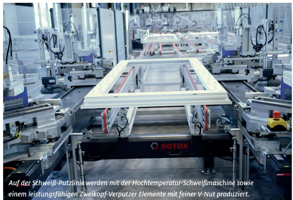
Auf der Schweiß-Putzlinie werden mit der Hochtemperatur-Schweißmaschine sowie einem leistungsfähigen Zweikopf-Verputzer Elemente mit feiner V-Nut produziert.
