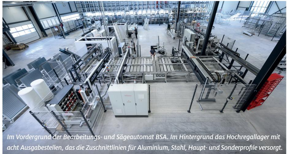
*Im Vordergrund der Bearbeitungs- und Sägeautomat BSA. Im Hintergrund das Hochregallager mit acht Ausgabestellen, das die Zuschnittlinien für Aluminium, Stahl, Haupt- und Sonderprofile versorgt.*
