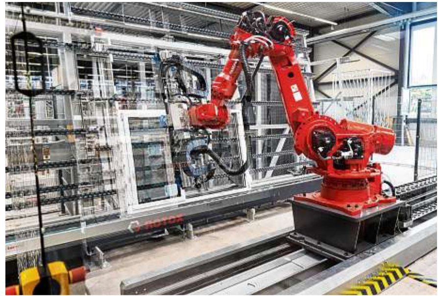
Der Einglasroboter setzt vollautomatisch das Glas in den Rahmen ein.
