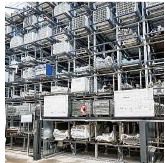
Das neue vollautomatische Hochregallager nimmt den Mitarbeitern schwere körperliche Arbeit ab.
